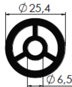
TUBO COM GUIA 25,4 X 3 X 0,65MM
